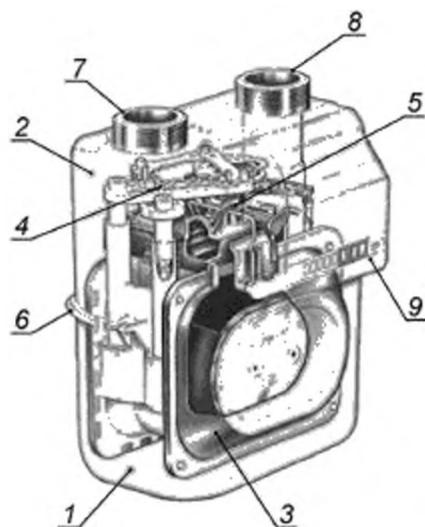
1 — корпус; 2 — крышка; 3 — мембрана; 4 — «дивошигно-рычажный механизм»; 5 — клапаны газораспределительного устройства; 6 — стяжная полоса; 7, 8 — входной и выходной штуцера; 9 — отсчетное устройство
