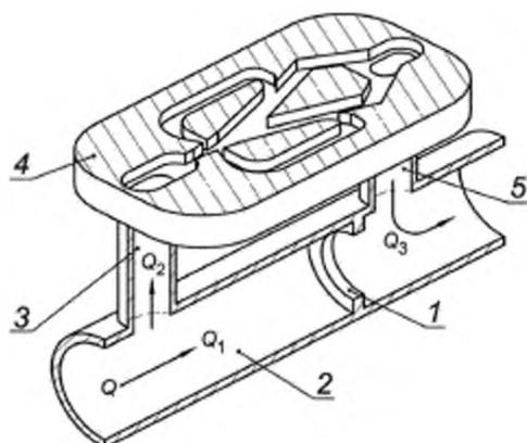
1 — устройства формирования перепада давления, 2 — труба (проточная часть), 3, 5 — соединительные трубы.
