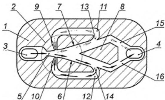
1 — корпус; 2 — струйный элемент; 3 — входное отверстие; 4 — выходное отверстие; 5 — сопло питания; 6, 7 — наклонные стени диффузора; 8 — разделитель; 9, 10 — сопла управления; 11, 12 — соединительные каналы обратной связи; 13, 14 — приемные каналы; 15, 16 — выходные каналы
